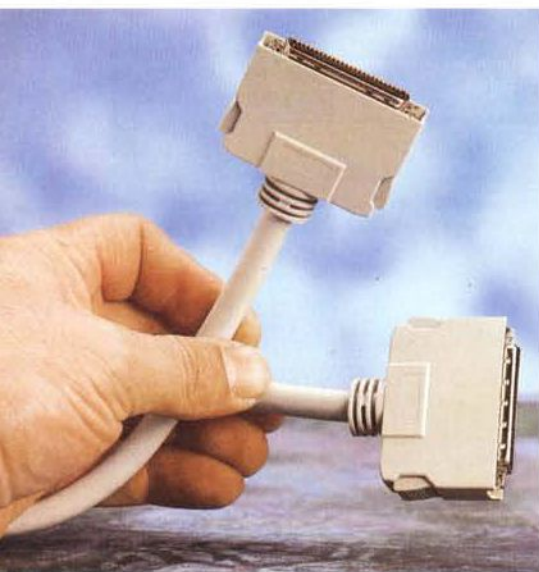
Il cavo utilizzato per la prova, fornito dal distributore, è del tipo SCSI 2 con connettori D-SUB 25 e Amphenol half-pitch 50.
